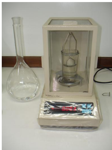
Figura 7 – Balança hidrostática utilizada neste trabalho, mostrando como uma gema fica imersa na água destilada para que seja feita a medição de sua densidade. (Fotografia dos autores)
