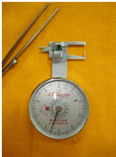
Figura 6 – Paquímetro gemológico de marca Leveridge utilizado nesta pesquisa. (Fotografia dos autores)
