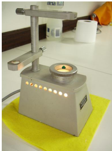
Figura 9 – Polariscópio utilizado neste trabalho, com uma gema posicionada para análise entre os dois polaróides – um na parte inferior do aparelho (sobre o qual está a gema) e outro no suporte mais acima. (Fotografia dos autores)
