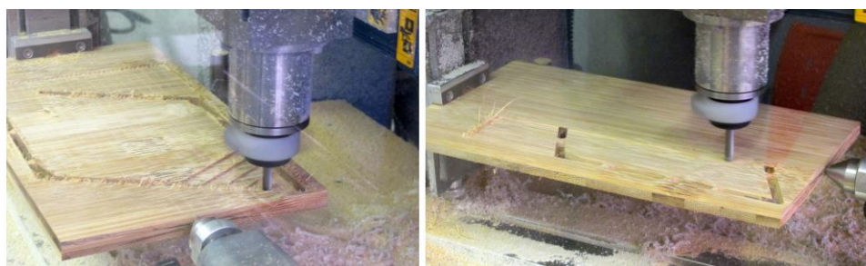
Figura 23 - Usinagem da peça com chanfro: desbaste de uma superfície. Usinagem da superfície posterior e correção de defeitos da placa Fonte: Yamada (2016)
