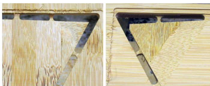
Figura 25 - Detalhe dos dois chanfros com acabamento finalizado: o da direita se quebrou durante o processo de usinagem. Fonte: Yamada (2016)
