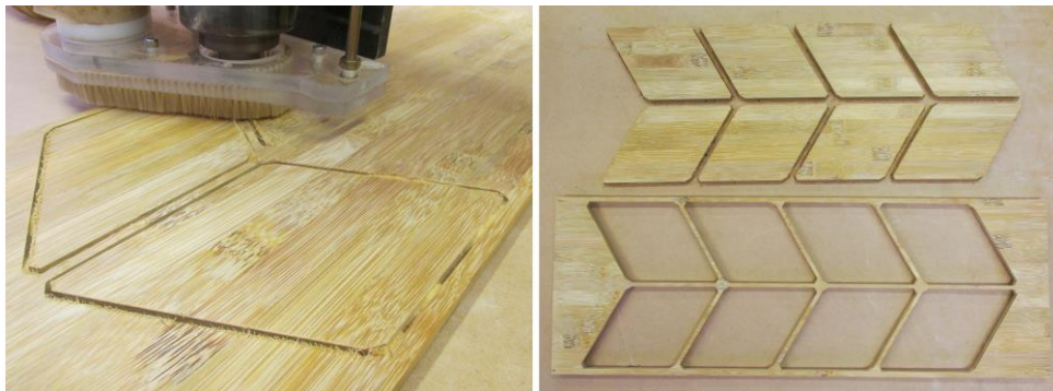
Figura 22 - Usinagem da placa (à dir.); peças usinadas e esqueleto da placa (à dir.). Fonte: Yamada (2016)
