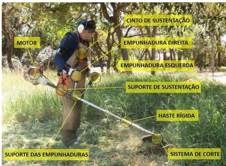
Figura 1: Operador, roçadeira lateral motorizada e seus componentes.
