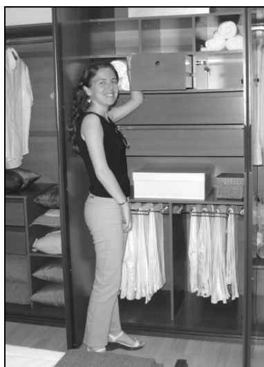
Figura 18 – Elevada altura do puxador da gaveta ao piso
