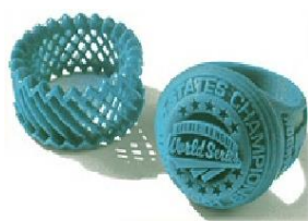
Figura 6. Protótipos em resina termoplástica, confeccionados através de um sistema CAM ligado a uma máquina de prototipagem rápida. Fonte: www.solid-scape.com
